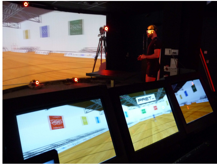
Fig. 2.6 - Salle de réalité virtuelle composée d'une station de contrôle, de vidéoprojecteurs, d'un écran semi-cylindrique et de lunettes stéréoscopiques.
